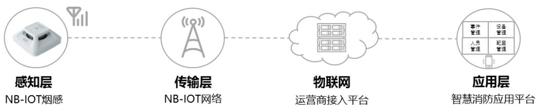
Fig1 典型 NB-IoT 探测报警器组成部分
