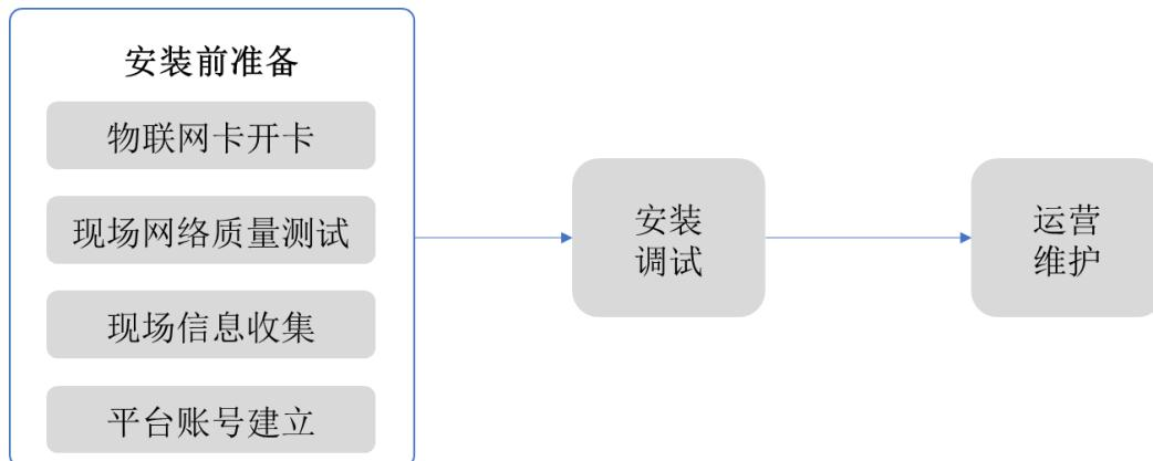
Fig2 NB-IoT 烟、温感主要安装调试过程
